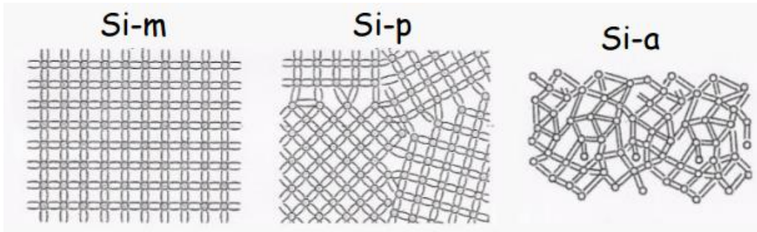
Figura 2.8. Esquema de la estructura atómica de un material monocristalino, policristalino y amorfo.
