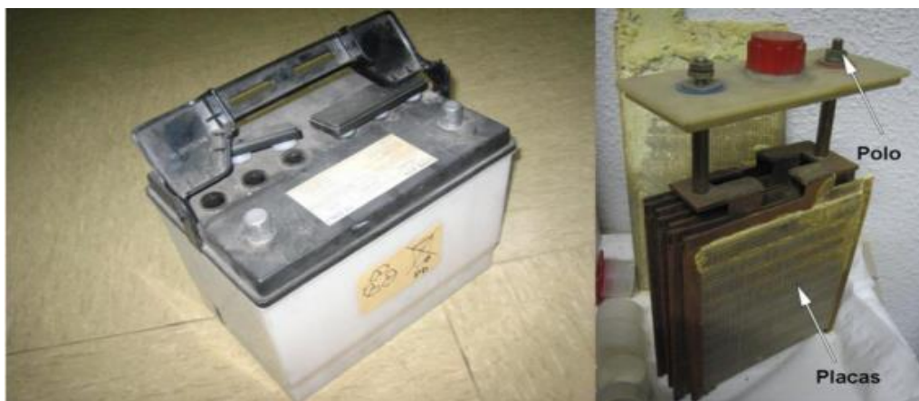
Figura 2.16. A la izquierda batería Pb-acido para uso en instalación fotovoltaica. A la derecha batería de Pb-acido sin vaso ni electrólito.
