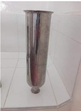
Fig.15. Carcasa del filtro actual del fermentador
