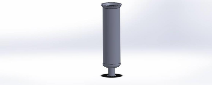
Fig.17.Carcasa del filtro propuesto para loa recirculación.
