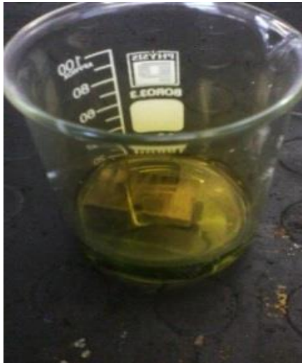
Fig 9. Activación y decapado de las probetas de acero con HCl al 5%
