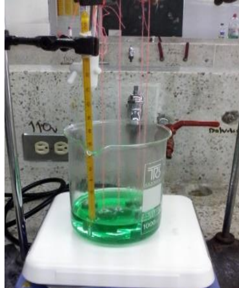
Fig 12. Adecuación del baño de plateado
