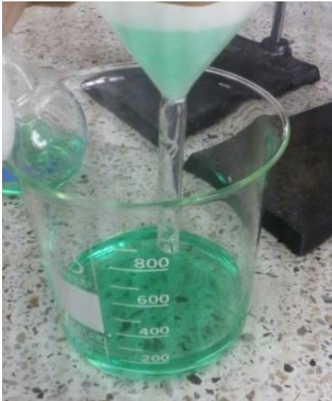
Fig 11. Filtración de la solución de plateado
