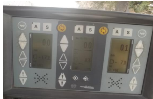
Figura 21: tablero de indicador de estado de la fresadora
