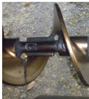
Figura 25: tornillo sinfín de distribución de asfalto
