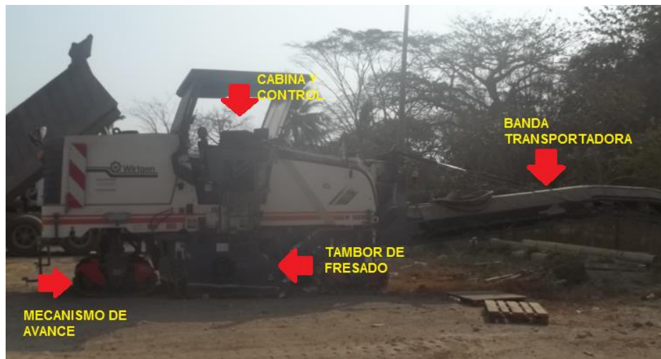
Figura 26: sistema de desgaste de Wirtgen
