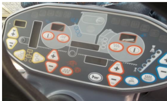
Figura 23: tablero de control del compactado
