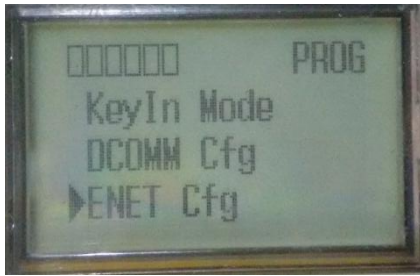
Figura 35. Display PLC configuración Ethernet.
