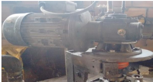
Figura 5. Motor de agitación reactor de plastificante.
