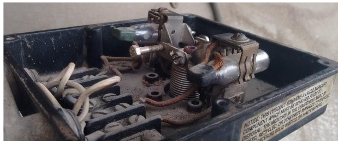
Figura 12. Interruptores de mercurio
