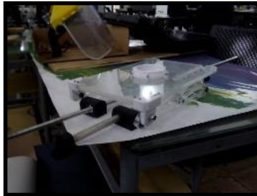
FIGURA 60: MECANISMO GRÚA TIJERA RECIÉN CONSTRUIDO.
