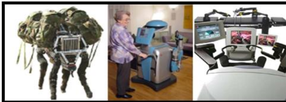
FIGURA 2 IZQUIERDA: BIG DOG, ROBOT MILITAR DISEÑADO PARA TRASLADAR CARGAMENTO. CENTRO: ROBOT DISEÑADO PARA LA ATENCIÓN DEL ADULTO MAYOR. DERECHA: ROBOT ZEUS DISEÑADO PARA EL USO DE SALA DE CIRUGÍA. [2].
