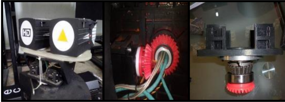
FIGURA 25: IZQUIERDA MECANISMO DE CUELLO EN EL EJE X, CENTRO ACOPLA PIÑÓN SERVO,
