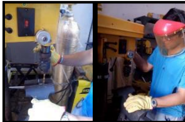
FIGURA 57: TRABAJO CON TALADRO DE ÁRBOL, FUENTE: AUTOR
