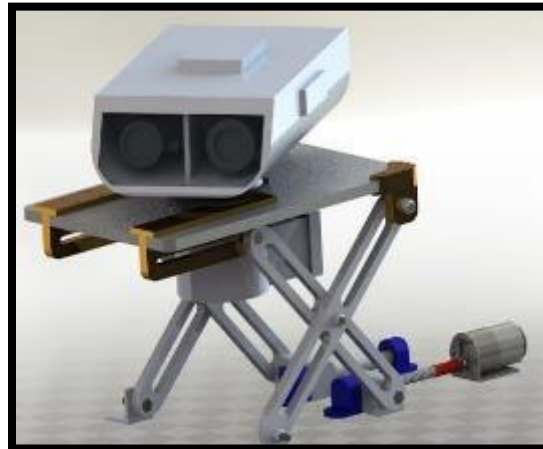
FIGURA 39: RENDERIZADO MECANISMO DE GRÚA TIJERA.
