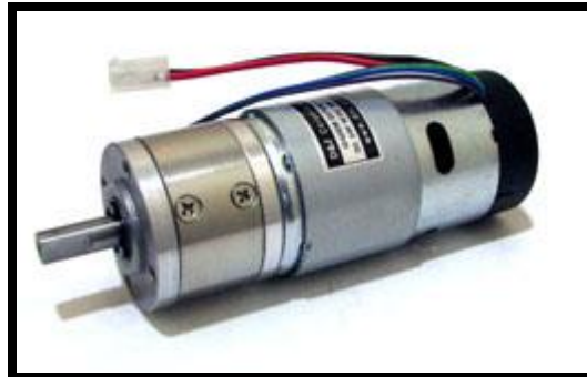
FIGURA 34: MOTOR USADO PARA MOVER LAS ORUGAS.
