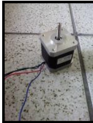
FIGURA 65: MOTOR PASÓ A PASO USADO MECANISMO DE CUELLO
