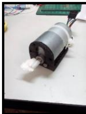
FIGURA 64: MOTOR USADO EN EL MECANISMO DE GRÚA TIJERA CON TORNILLO SIN FIN.
