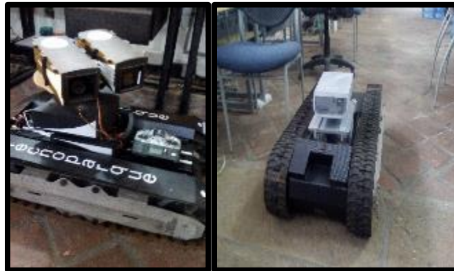
FIGURA 87 DERECHA MÓDULOS DESCARRILADOS, IZQUIERDA MODELO MÁS COMPACTO
