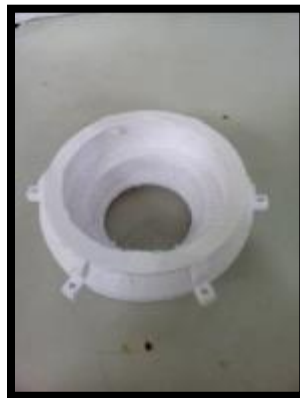
FIGURA 45: SOPORTE DE LAS ESQUINAS DEL ACRÍLICO
