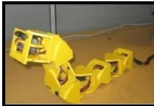
FIGURA 6: ROBOT MODULAR INSPIRADO EN EL MOVIMIENTO DE LAS SERPIENTES. [5].
