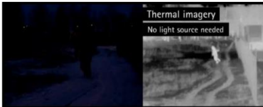
FIGURA 13: IZQUIERDA: IMAGEN CAPTADA POR EL OJO HUMANO. DERECHA: LA MISMA IMAGEN, CAPTADA POR UNA CÁMARA TÉRMICA. [11].
