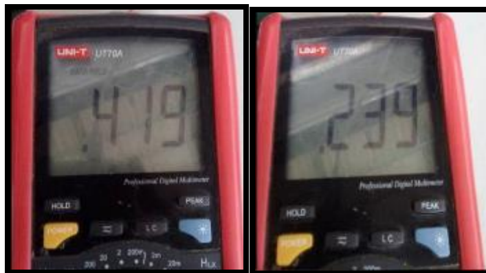
FIGURA 84: IZQUIERDA CORRIENTE DE ARRANQUE ANTERIOR, CORRIENTE DE ARRANQUE ACTUAL.
