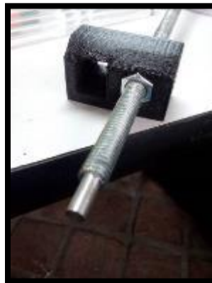
FIGURA 51: ACOPLA DE ARRASTRE TORNILLO SIN FIN, FUENTE: AUTOR
