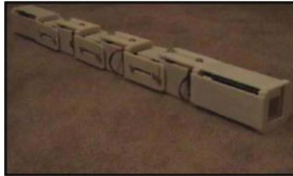
FIGURA 7: ROBOT MODULAR INSPIRADO EN EL MOVIMIENTO DE SERPIENTE. [6].
