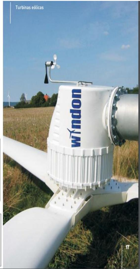
Figura 35: Aerogenerador Windon de 20 kW (wattnier, 20016)
