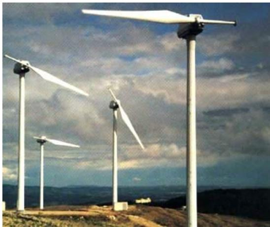
**Figura 9: Aerogenerador Monopala**
