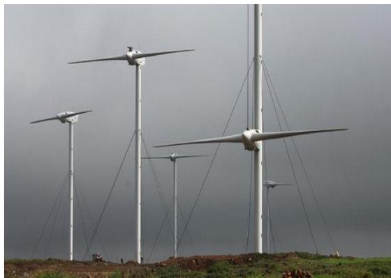
**Figura 10: Aerogenerador Bipala**
