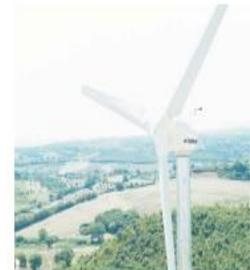
Figura 36: Aerogenerador Windon de 30 kw (wattnier, 20016)
