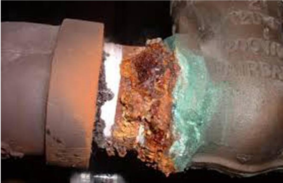
Ilustración 6. VÁLVULA CON EFECTOS DE CORROSIÓN. China, corrosión y protección de la red. Autor. Li Lingshan.
