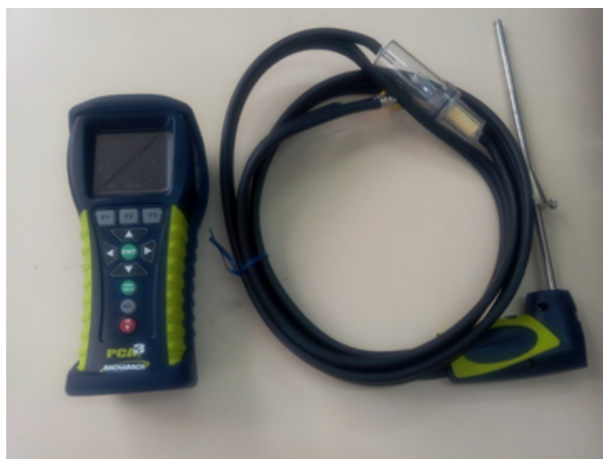
Figura 3-1: Analizador de gases marca Bacharach modelo PCA 3 275, utilizado en este proyecto. Tomado de: El autor.
