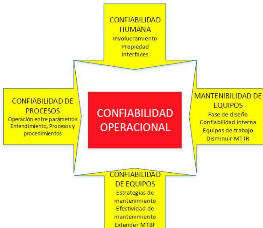
Figuras 13 Aspectos de confiabilidad operacional.
