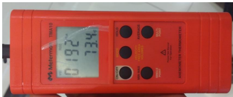
Figura 14. Velocidad y temperatura de la corriente de aire detectada en el cielo raso del 4to piso.
