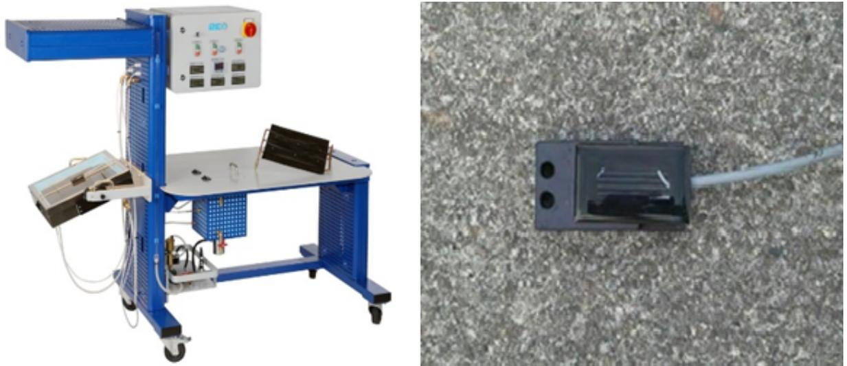
**Figura 3-11:** Equipo de medición de la radiación solar y sensor usado en campo para la medición de esta. a. Equipo GUNT ET 202 b. Sensor de radiación
