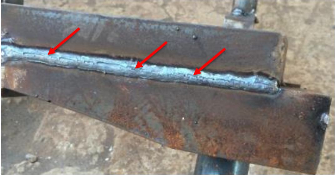
Figura 34. Porosidad en soldadura serie 200. (Autor)
