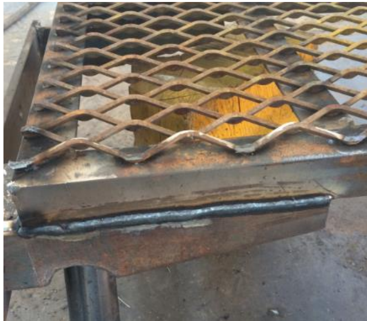
Figura 39. Corrección de serie 200 en el proceso de soldadura
