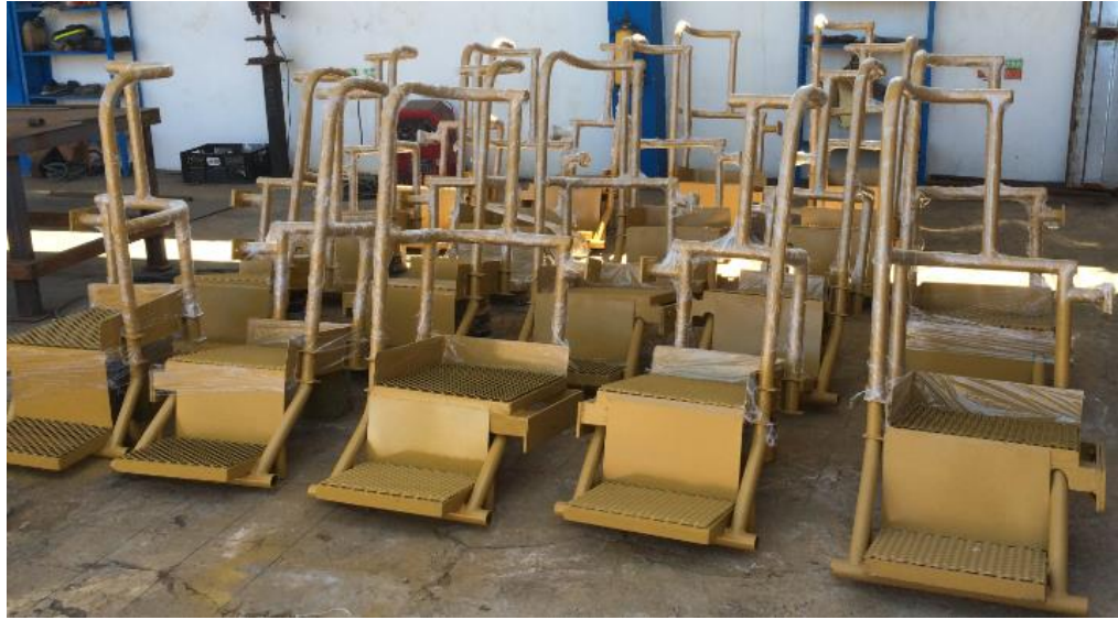
Figura 41. Protección mediante envoltura plastica de las plataformas. (Autor)
