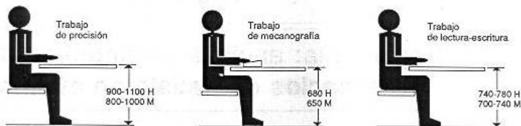
Fig. 2.2 Altura del plano de trabajo para puestos de trabajo sentado (medido en mm)
