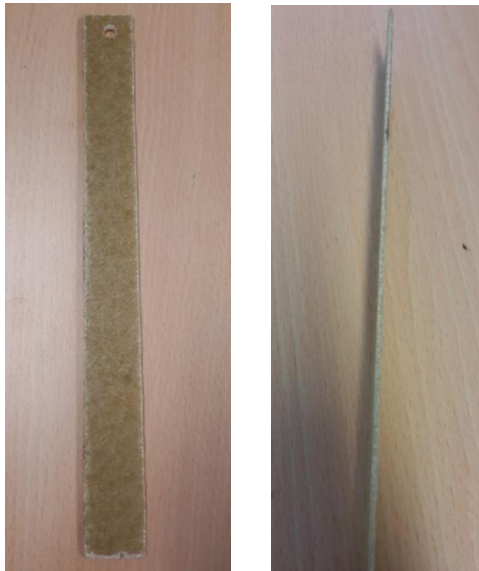
Figura 27. Arreglo bio-epoxy y fibras de vidrio
