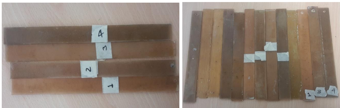
Figura 23. Probetas arreglo de matriz termoestable poliéster y con refuerzo fique en configuración aleatoria
