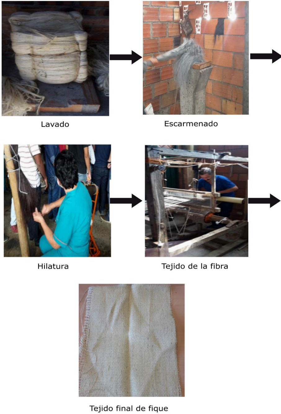
Figura 17. Proceso para la obtención del tejido de fique
