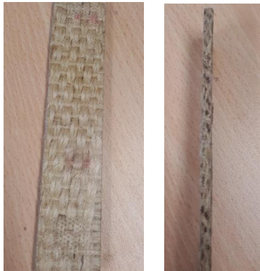
Figura 26. Arreglo bio-epoxy/ fique en configuración de tejido
