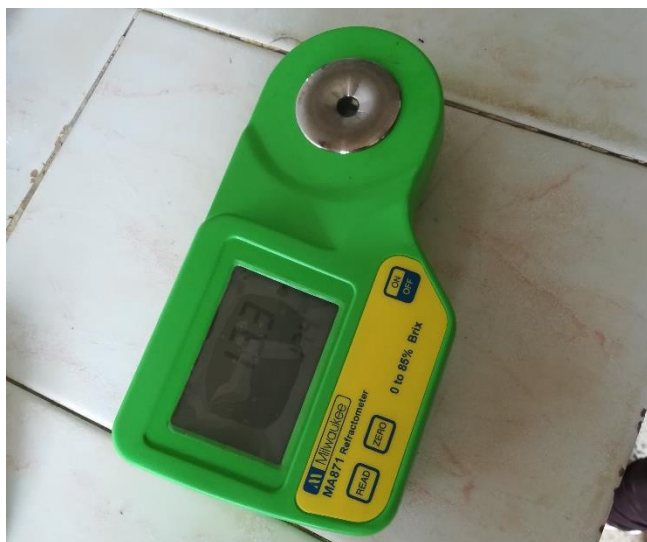
Figura 12. Refractómetro digital MA871 Milwaukee utilizado para medir °Brix. Fuente: Propia.
