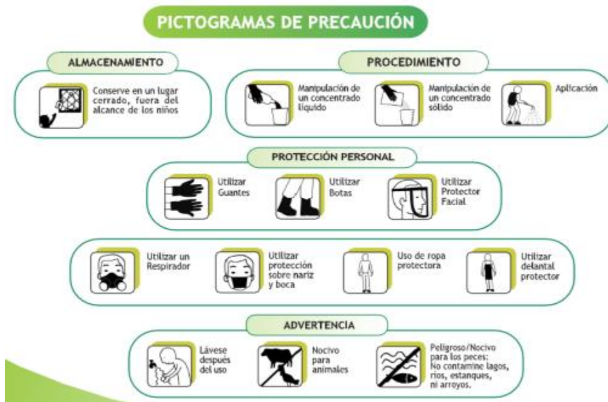
Figura 60. Pictogramas de precaución al momento de hacer uso de un agroquímico. Pinto G. (2012).
