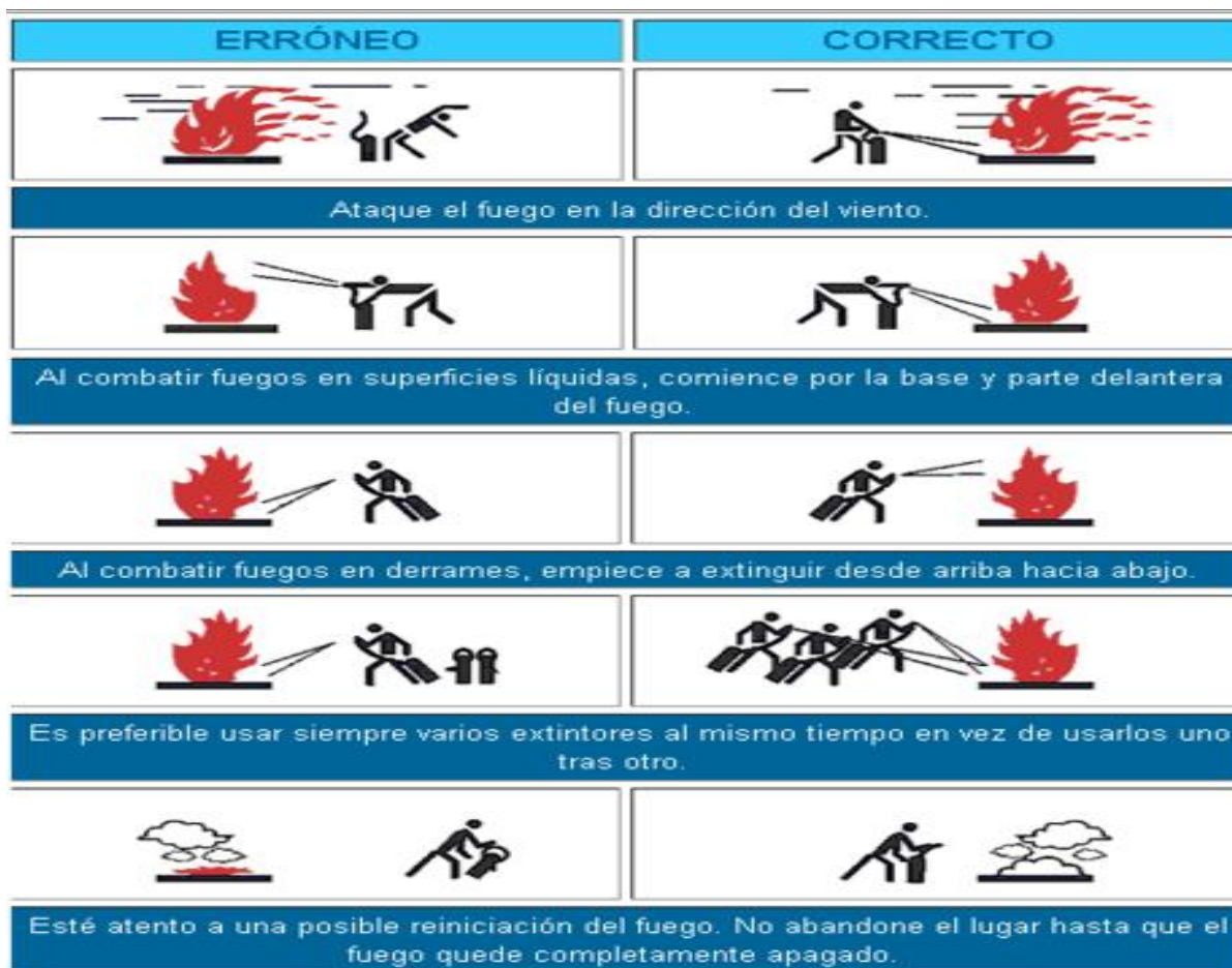
Figura 73. Como actuar cuando se presenta un incendio. Sánchez L. (S.f). Tomado de https://bit.ly/2ICzbNz
