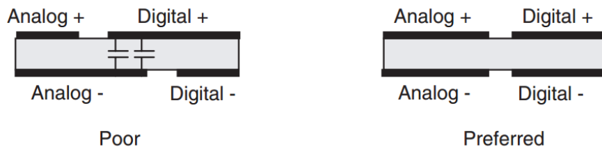
Figura 3-4.: Superposición de planos analógicos y digitales en una PCB [14].
