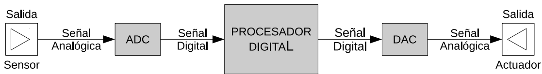
Figura 2-3.: Esquema general de un sistema DSP [3, p. 4].
