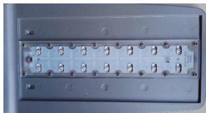
Figura 28. Panel Led. Tomada de: Concesión de Alumbrado Público.
