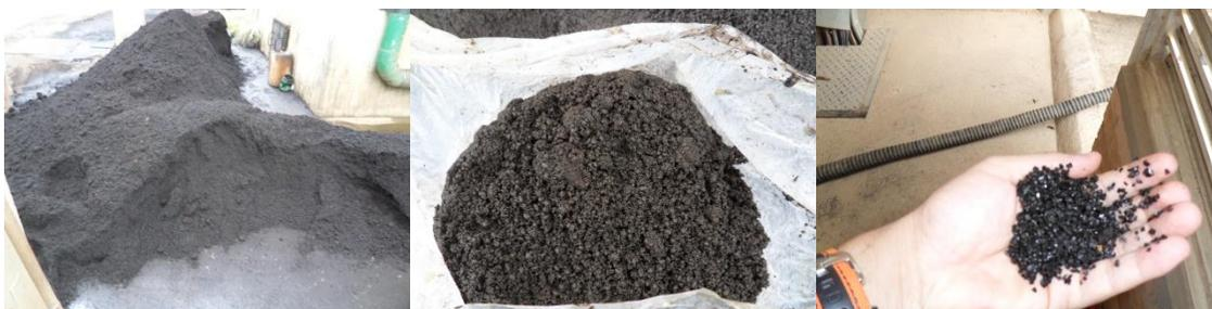
Figura 8. Lecho filtrante sobresaturado.
