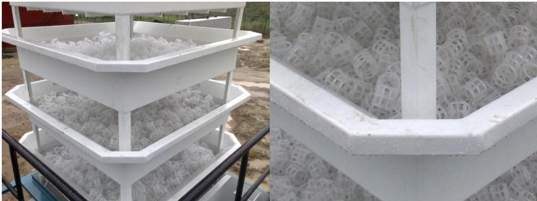
*Figura 5. Bandejas de aireación propuestas.*
