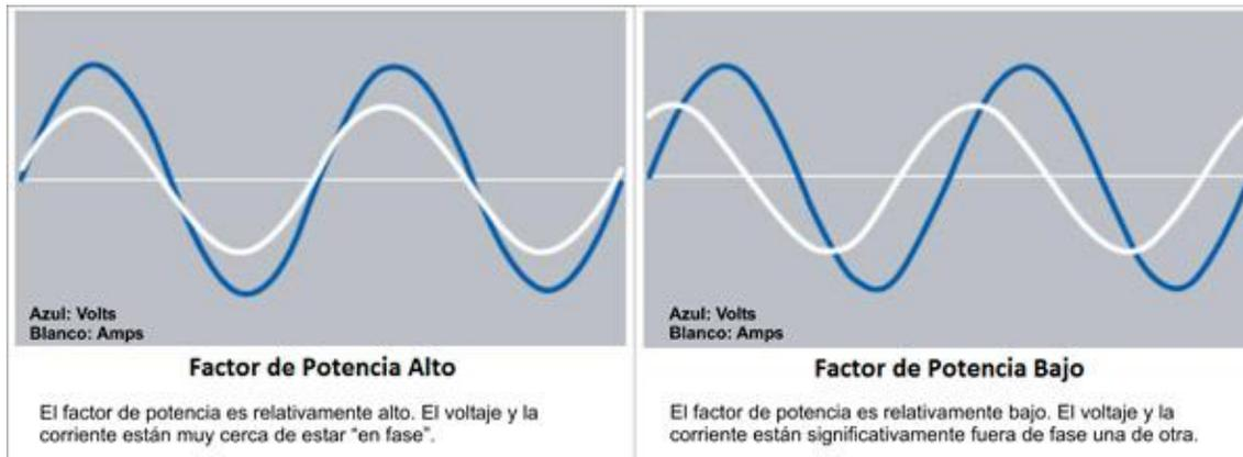
*Figura 22. Diferencias entre factores de potencia.*
