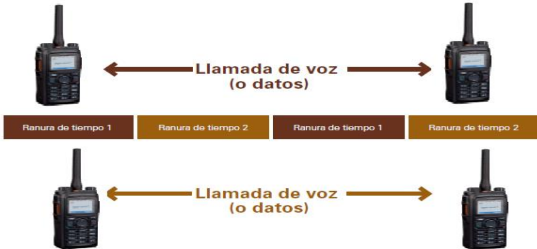
Figura 20 Técnica TDMA para división del canal.
