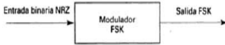
Figura 12 Diagrama entrada y salida de un modulador FSK.
