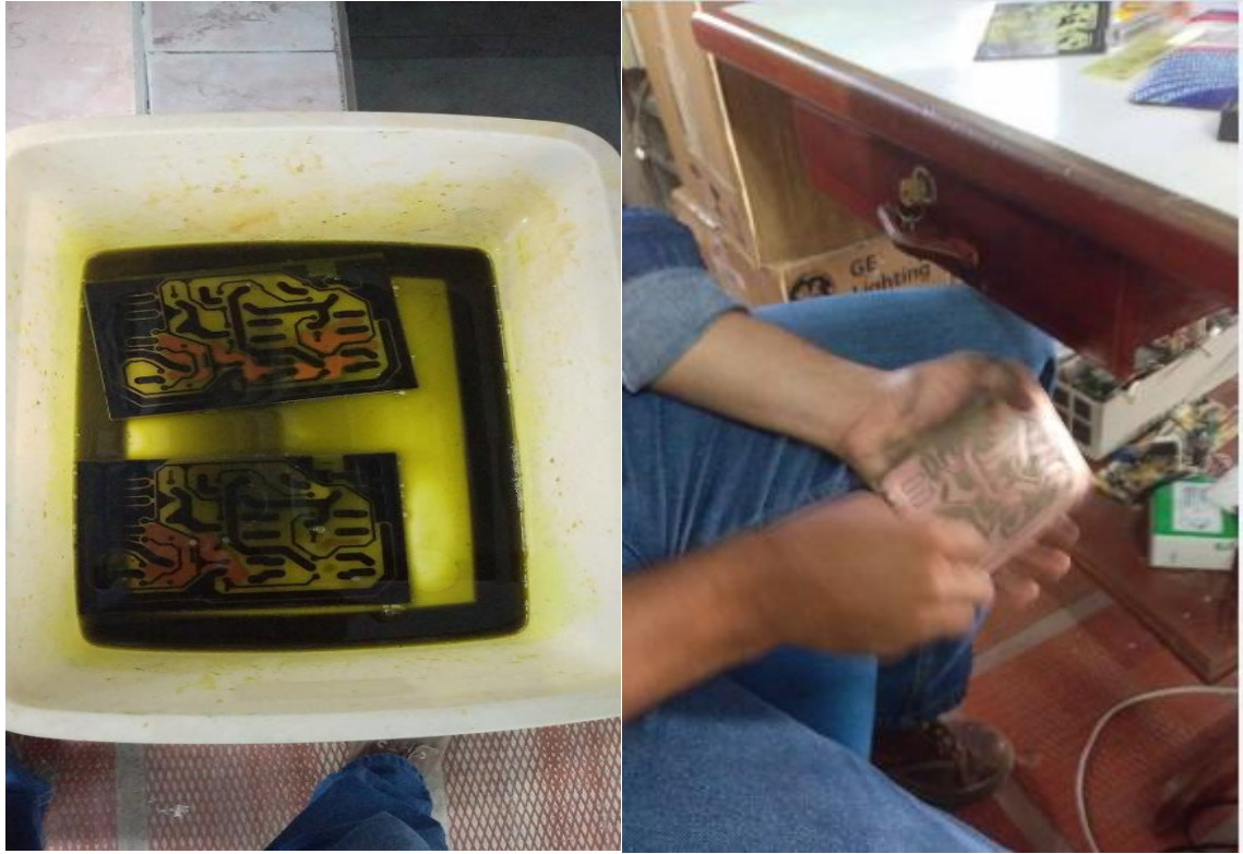
Figura 33: a) y b) Impresión de la PCB en baquela [Fuente. El autor].
