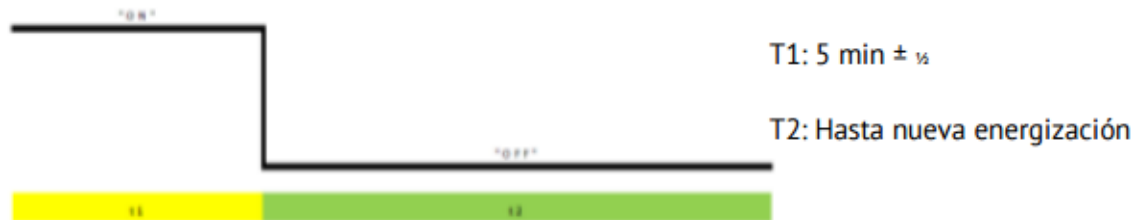
Figura 3: tiempos de operación de un arrancador [22].
