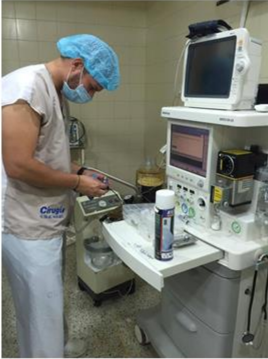
Mantenimiento a maquina de anestesia, realizando calibracion del equipo.
