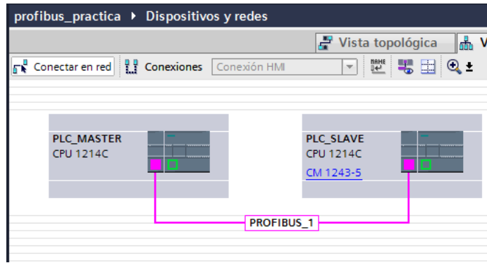
Ilustración 123 ENLACE ENTRE LOS DOS PLC's
