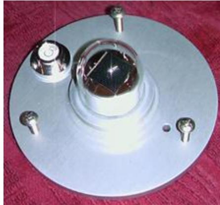
**Figura 29. Mk 1-G Sol-A-Meter PIRANOMETRO (RADIACION SOLAR). [37]**
