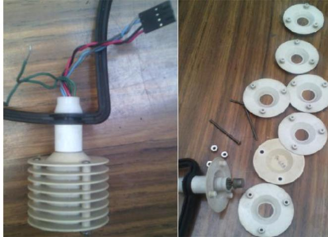
**Figura 17. Sensor de Temperatura.**
