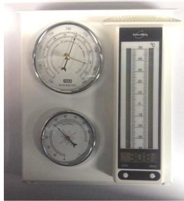
**Figura 2. Estación meteorológica análoga. [20]**
