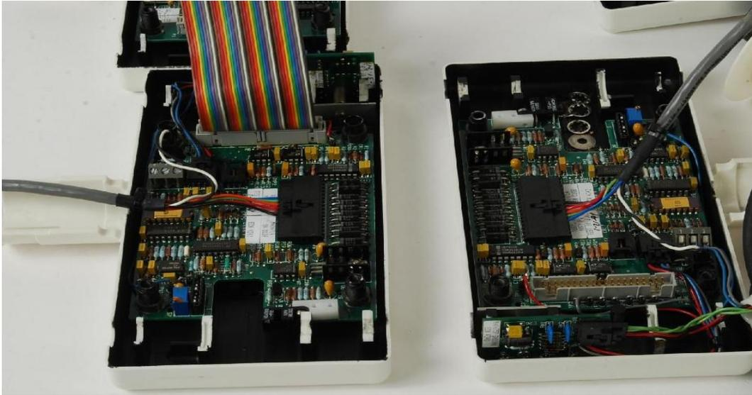
**Figura 7. Interior del circuito original de sensores de la Estación meteorológica. [38]**
