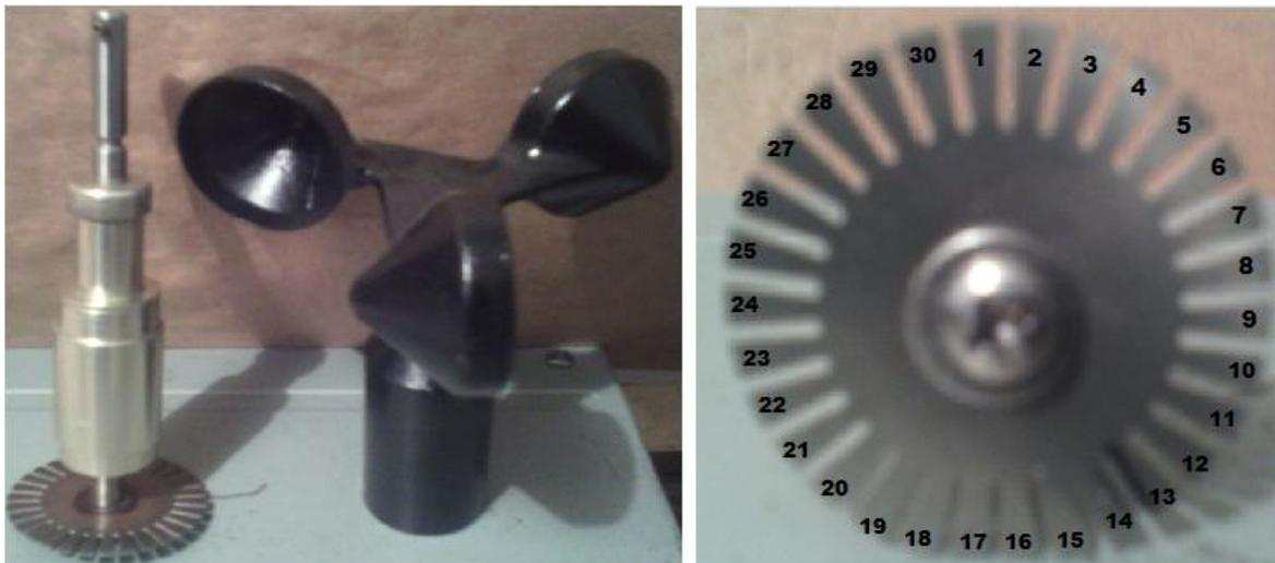
**Figura 24. Cazoletas y sistema para medición de velocidad del viento.**
