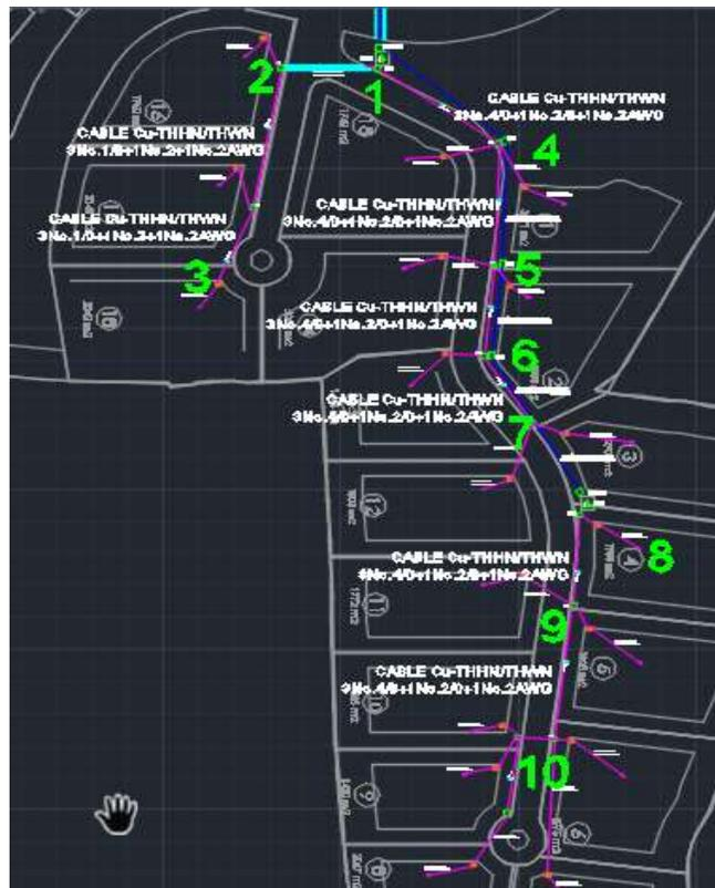
Figura 23 seccionamiento usado para el cálculo de conductores
