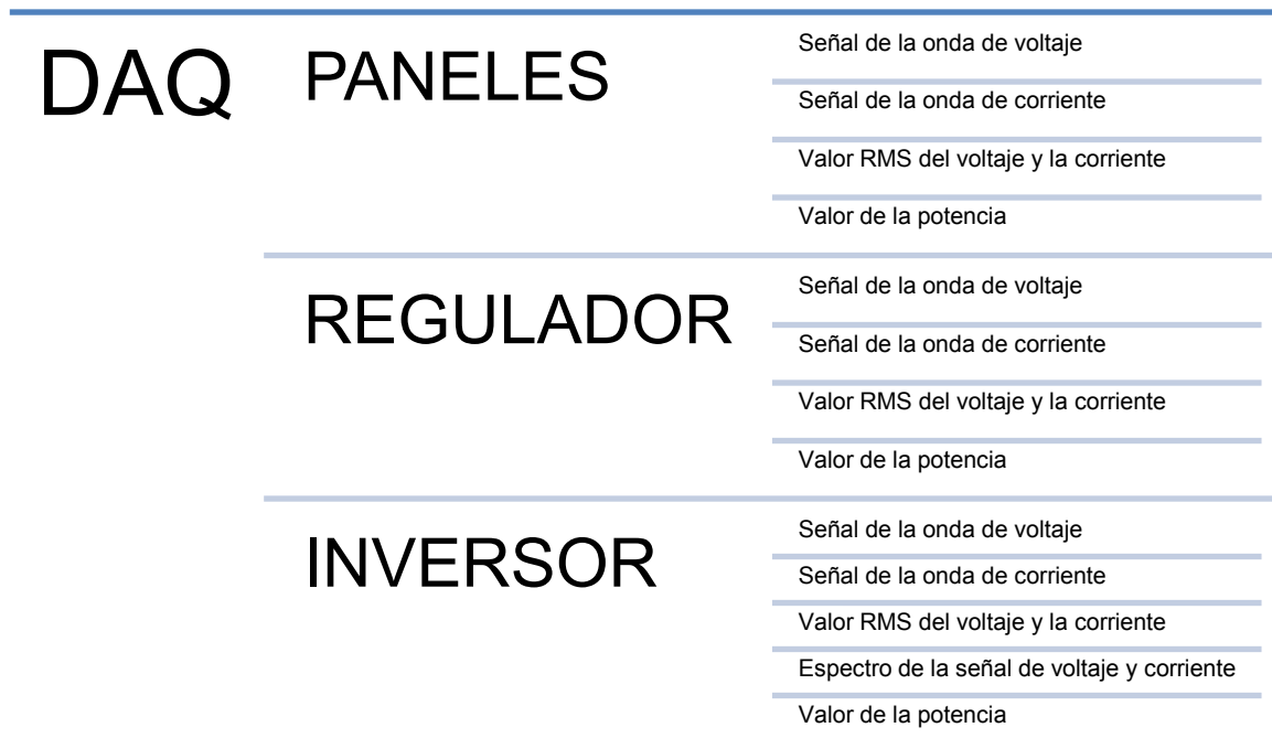
Figura 25. Esquema básico de la interfaz.
