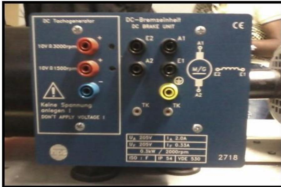
Figura 65 :Placa característica del generador DC.
