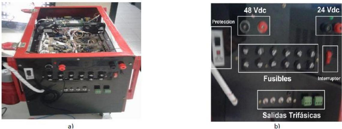
Figura 26: a. Prototipo con carcasa. b. Bornes de conexión.
