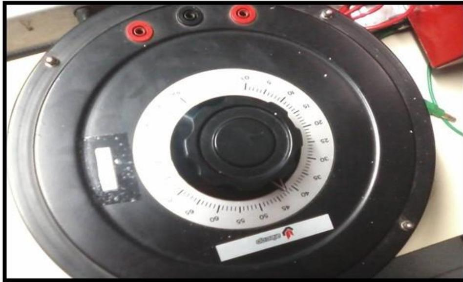
Figura 67: Reóstato utilizado en las pruebas.
