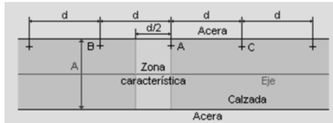
Figura 27 Separación de las luminarias
