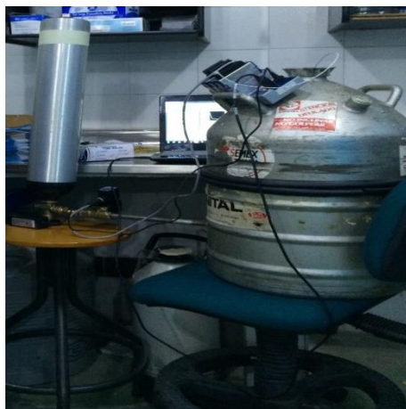
Sistema bala de oxígeno adaptada para nitrógeno líquido
