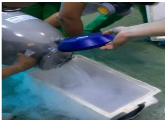
Figura 3. Vertimiento del Nitrógeno Líquido a la cava para su estabilización y alcance de nivel deseado
