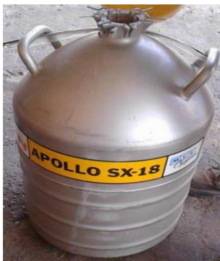
Figura 20. Tanque que se utilizó como cámara criogénica
