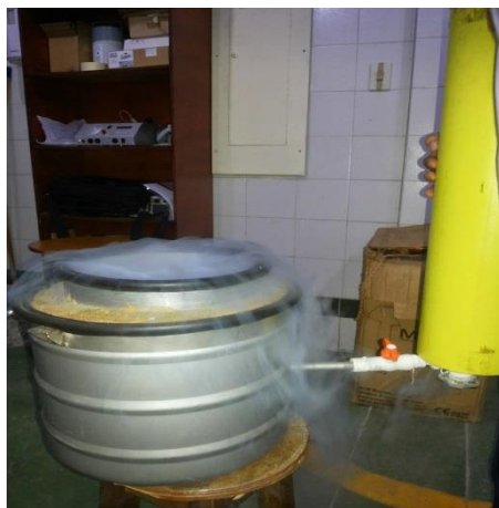
Sistema bala de oxígeno aislada térmicamente adaptada para nitrógeno líquido
