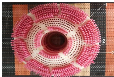
Figura 25. Vista del portapajillas en él se observan los anillos, 1) Anillo, 2) Orificio para depositar la pajilla, 3) Pajilla depositada
