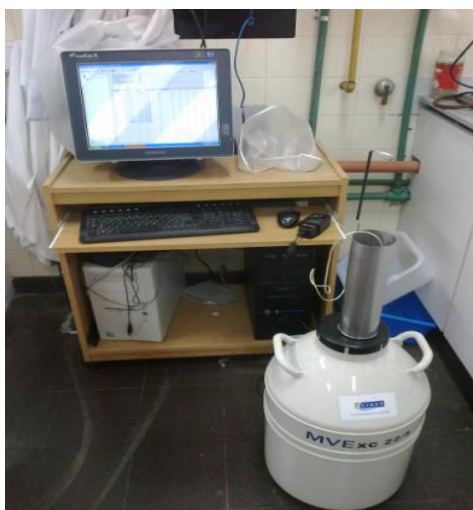
Figura 8. Dewar recipiente lleno de LN2 y Testo Adquisición conectado a un PC
