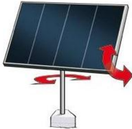
Figura. 19. Movimientos de un seguidor solar de dos ejes.[24]
