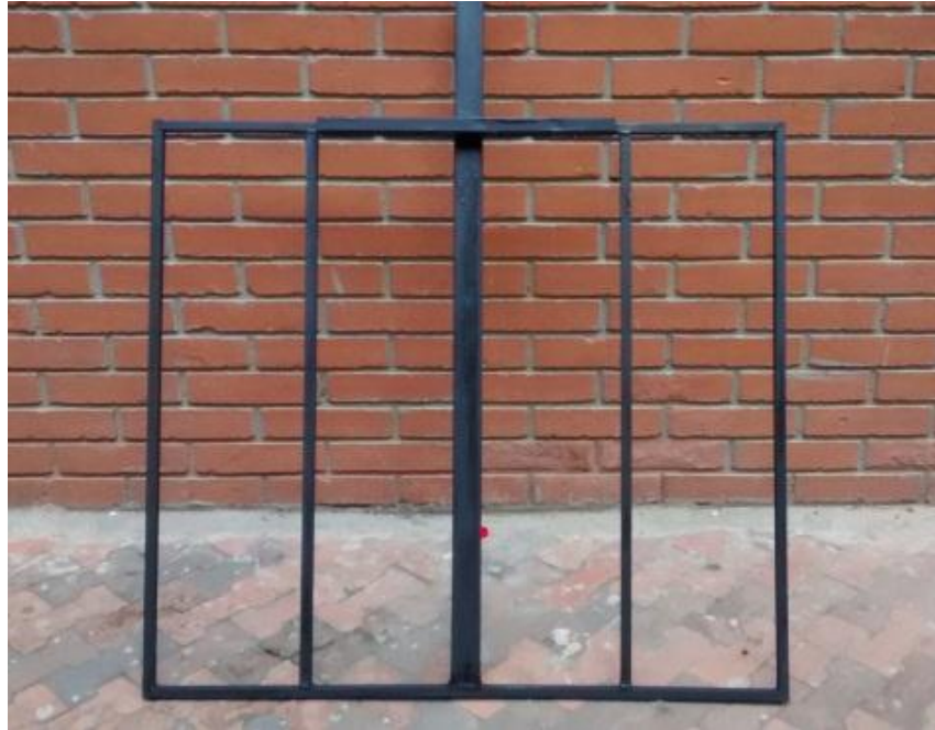
Figura. 23. Estructura de soporte para los paneles fotovoltaicos.
