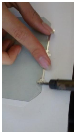
Figura. 26. Soldadura de conectores de celdas fotovoltaicas
