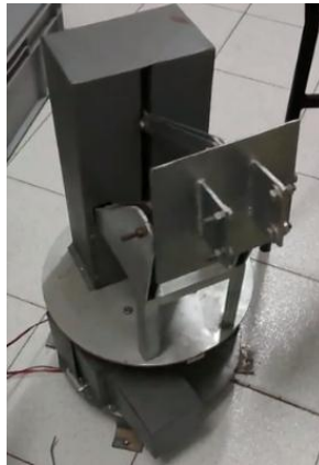
Figura. 21. Estructura mecánica para seguimiento de altura y acimut solar
