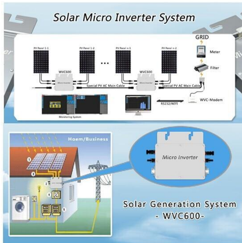
Figura. 50. Monitoreo del conjunto de Micro inversores[13].
