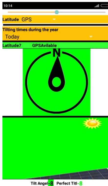
Figura. 42. Posicionamiento de paneles solares con aplicativo móvil PV Solar Power System
