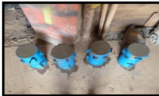
97 Cilindros de muestra para prueba de triturado. Fuente: Autor (2016)
