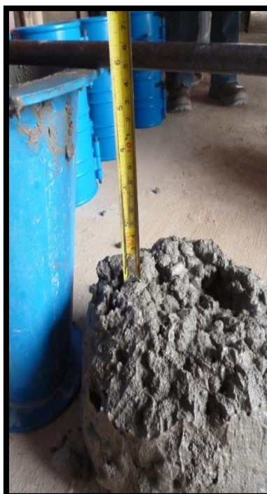
101 Asentamiento de 15 cm para vigas. Fuente: Autor (2016)
