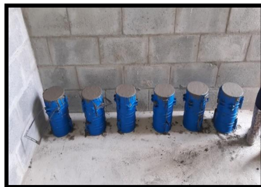
99 Cilindros de muestra para placa de entepiso (3 por cada 2 torres).
