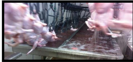
Figura 8. Lavado en tanque de inmersión de la planta de beneficio.
