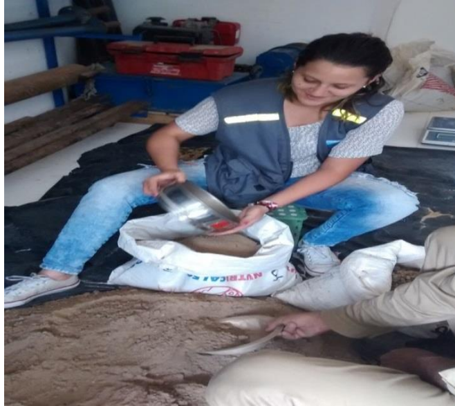
Figura 17. Tamizado para ensayo de Proctor Modificado
