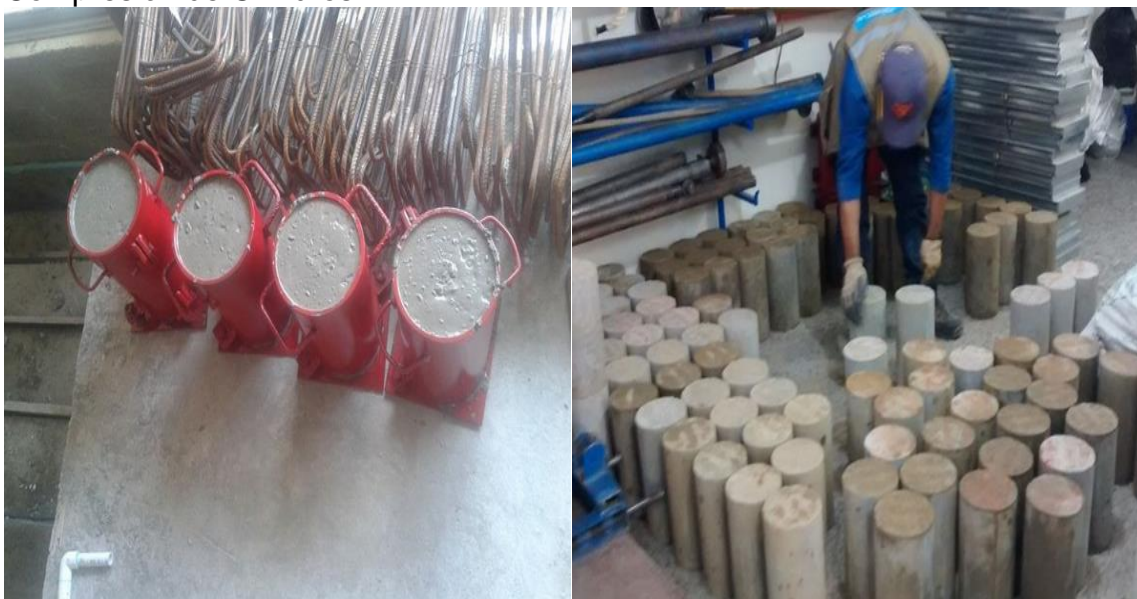
Figura 27. Toma de Muestras y Testigos para el Ensayo de Resistencia a la Compresión de Cilindros
