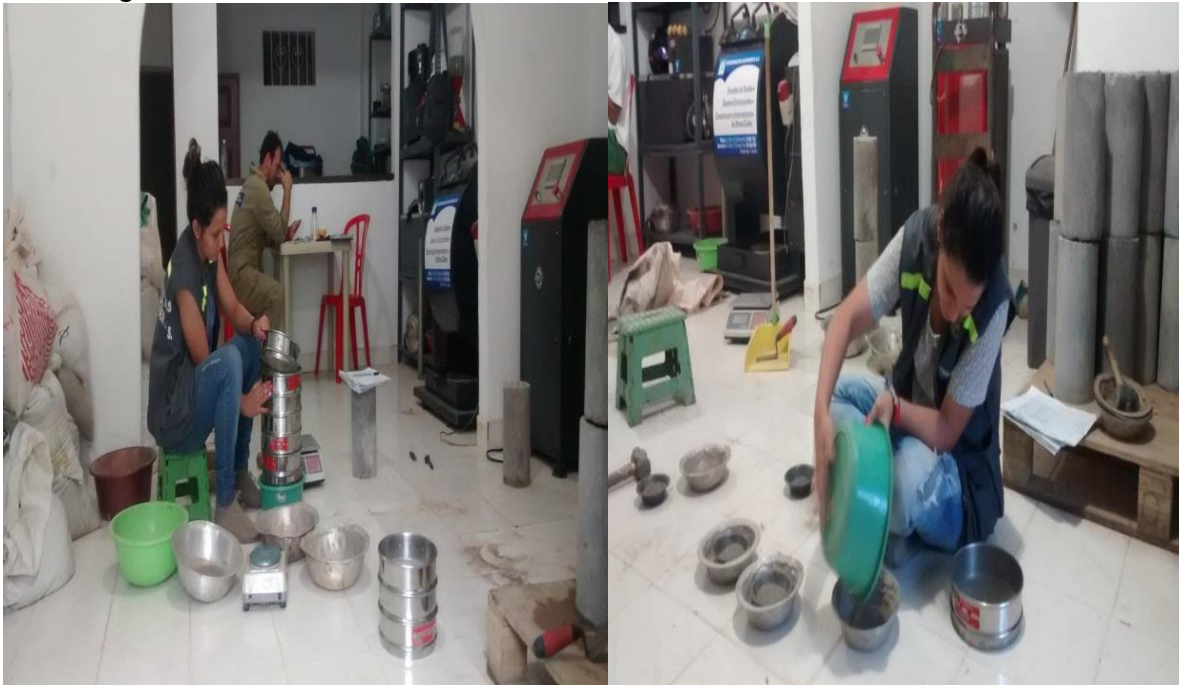
Figura 29. Tamizado para Análisis Granulométrico y Ensayo de Limites de Atterberg
