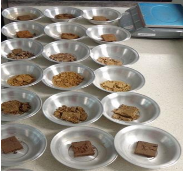
Figura 30. Muestras del Ensayo de Proctor para Determinar el Contenido de Humedad.
