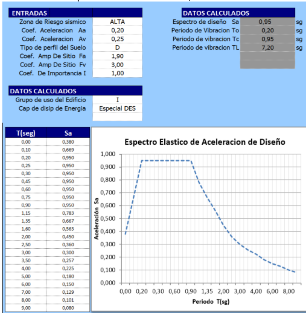
Figura 8. Calculo del espectro de diseño. NSR-10, A.2.6
