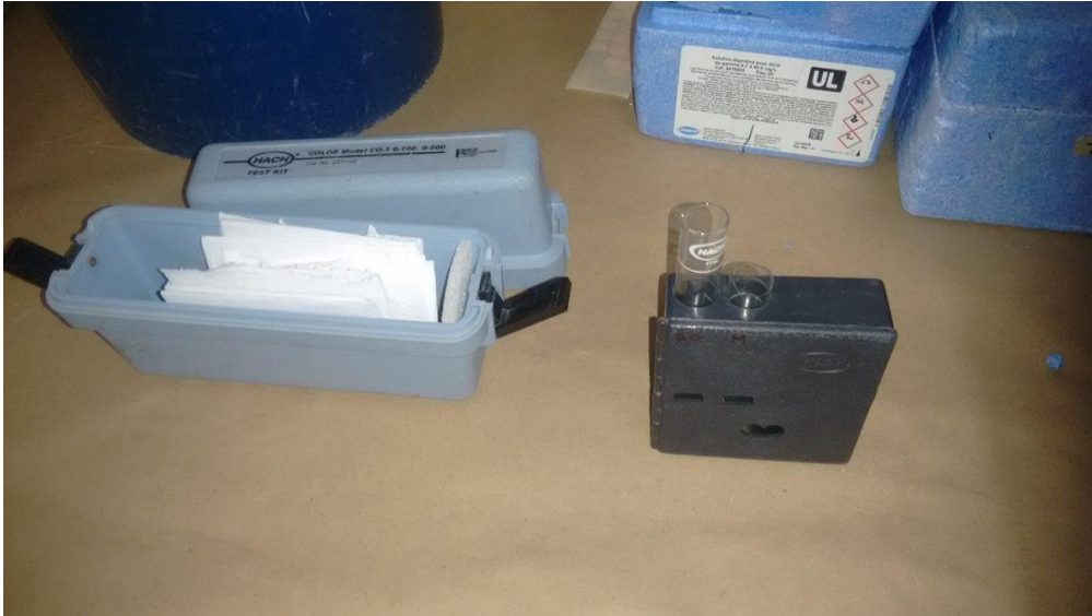
Foto 13. Equipo de laboratorio para determinar el color, colorímetro.
