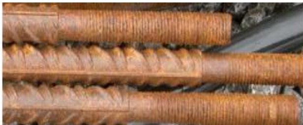
Ilustración 8: anclaje barra real
