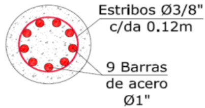
DETALLE ACERO DE REFUERZO MICROPILOTE D=25cm
