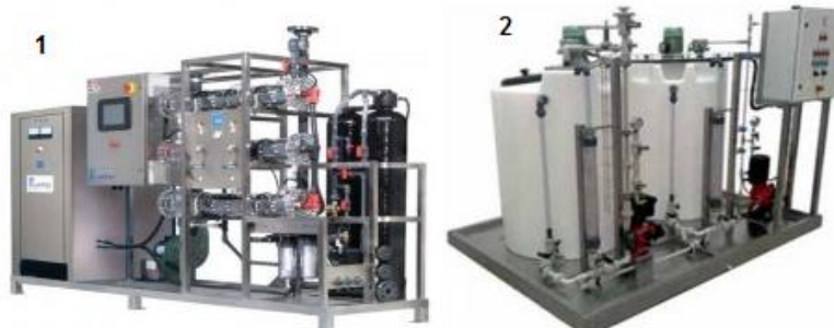
Imagen 15. Equipos utilizados para dosificación de plata ionizada.
