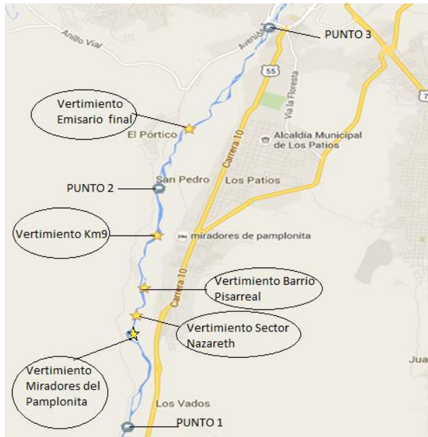
Imagen 6. Puntos de vertimiento en el tramo.
