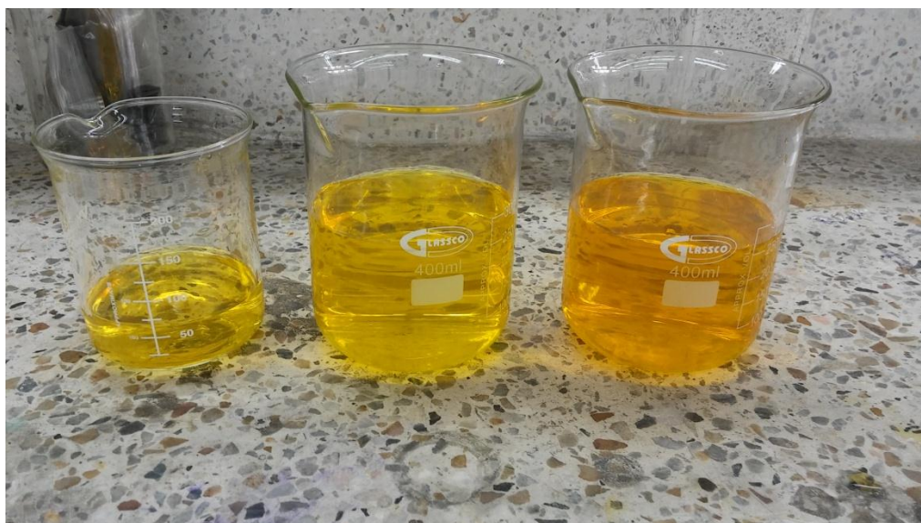
Figura 11. Solución de K_2CrO_4 , con pH básico, neutro y ácido respectivamente siendo básico el de la margen izquierda.
