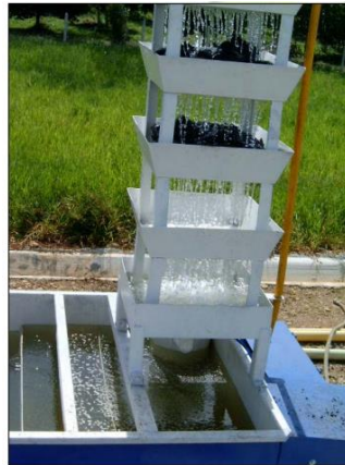
Figura 14. Torre de aireación Fuente: (KNOCOLOMBIA, 2014)
