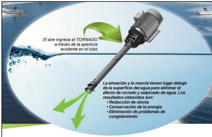
Figura 18. Funcionamiento del aireador Tornado. Fuente: (RWL WATER, 2016)
