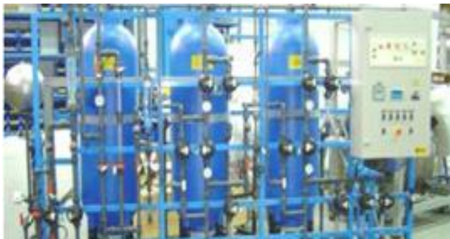
Ilustración 4 Intercambio Iónico – Electrodesionización (EDI)
