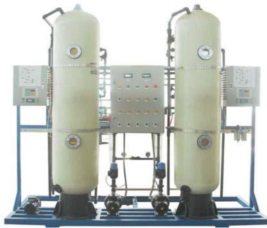
Ilustración 6 Desionización de Dos Camas
