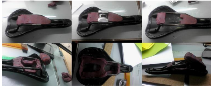
Foto 22 Configuración formal del elemento partiendo de una base de plastilina
