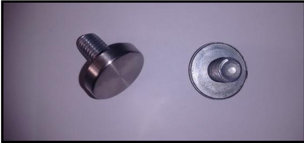
Ilustración 86 Tornillo 303 cabeza moletada (autor)
