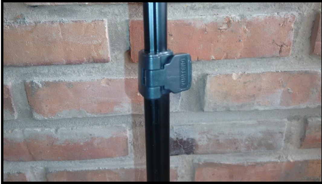
Ilustración 91 mecanismo de bloqueo (autor)
