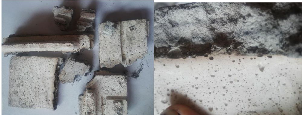
Ilustración 54. Módulo de yeso y aserrín después del proceso de cocción. Fuente propia
