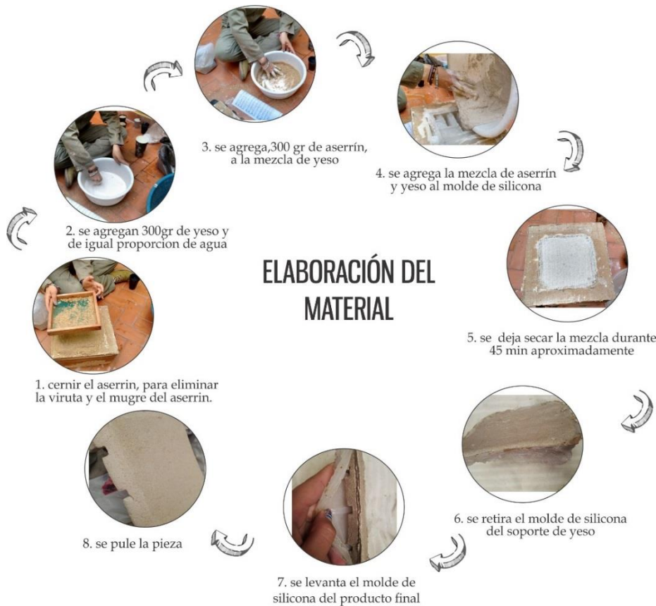
Ilustración 40. Proceso de elaboración del material
