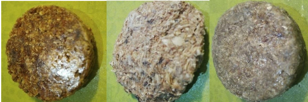
Ilustración 17. Pruebas realizadas con aserrín y resina, aserrín y almidón de yuca y aserrín y silicona. Fuente: propia
