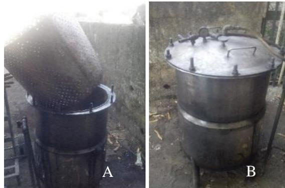
Figura 6. Fotografías de autoclave de Industrias Kjú. A: Recipiente interno, B: Autoclave sellado (González A, 2015)
