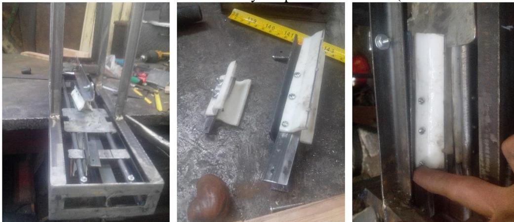
Fabricación de guías y correderas, ensamble de canales – cuchillas (González A. 2016)
