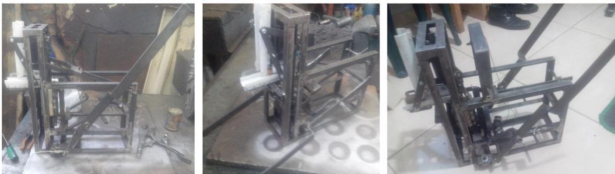
Construcción de poleas, ensamble de palancas y ajustes de guayas (González A. 2016)
