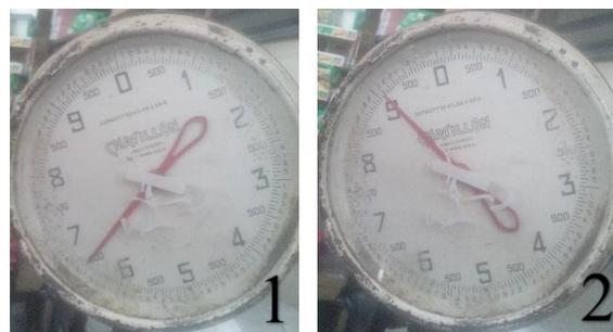
1 Peso requerido para accionar la palanca izquierda en el descortezado de semillas
