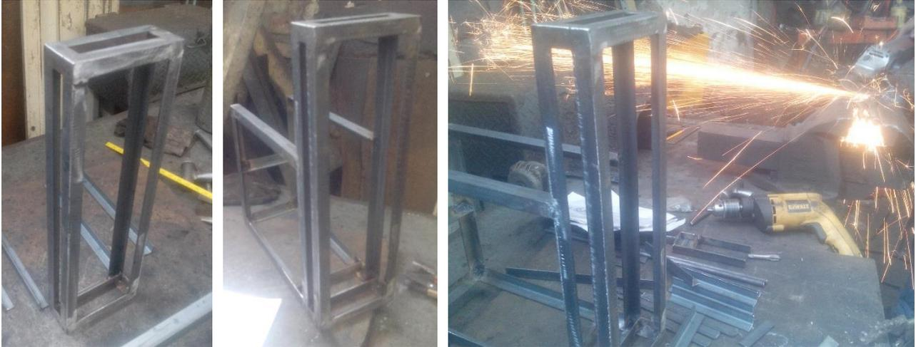
Fabricación de estructura base con ángulos de metal (González A. 2016)
