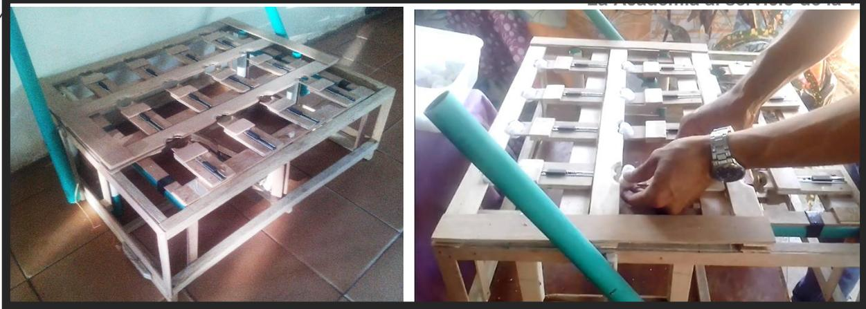
Este sistema tiene 12 compartimientos donde se acoplan las semillas a través de un sistema de cuchillas corredizas, en el cual son descortezadas con un sistema de doble palanca. El sistema procesa 12 semillas a la vez, pero al acomodarlas en cada compartimiento genera una demora de tiempo que a la final posee resultados parecidos a las descortezadoras tradicionales. (Ver anexo 5)
