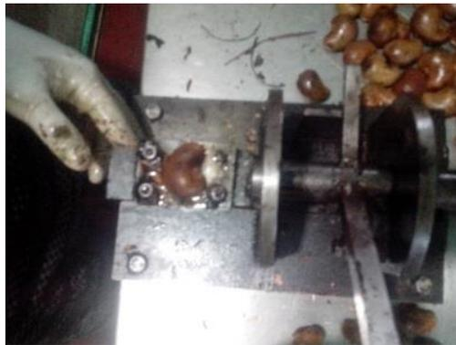
Figura 8. Herramientas descortezadoras manuales. Industrias Kjú (González A, 2015)
