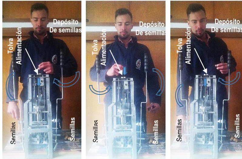
Cuando el canal de alimentación está lleno, el operario procede a tomar las dos palancas, una con cada mano, para halar primero la del lado izquierdo y poner en posición a una semilla en el canal de cuchillas longitudinal; luego se hala la palanca del lado derecho para que estas cuchilas la corten la cáscara por la mitad sin dañar la almendra, cayendo en un recipiente instalado debajo de la máquina.
