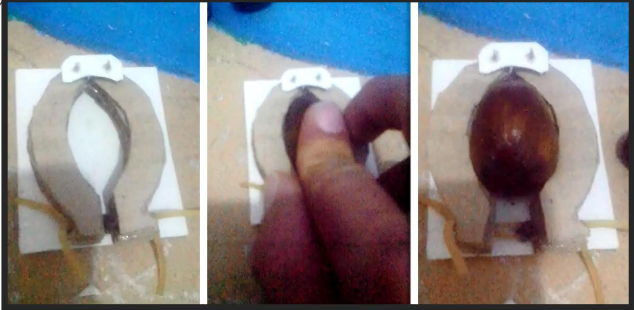
Este sistema permite acomodar las semillas en compartimientos que van girando en un tiempo determinado, donde un sistema de cuchillas automatizadas van penetrando y abriendo la cáscara de cada semilla. Para alinear cada sistema y hacer que funcionen correctamente hay que acoplarlos de una manera adecuada, haciendo mas compleja la máquina. (Ver anexo 6)
