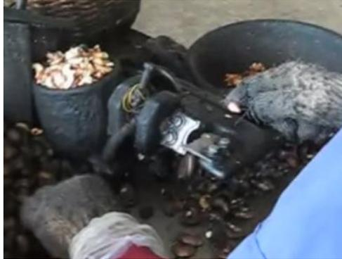
Figura 41. Descortezadora de dos pedales, Vietnam. Recuperado de Myminami, (2010)
