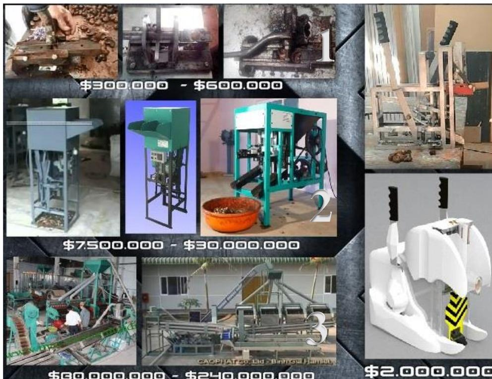
1 Máquinas descortezadoras locales (Kajú, 2016) 2 Máquina automática de descortezado (Sairaj, 2015) 3 Máquina automática de descortezado Cao Phat (Caophat, 2016)
