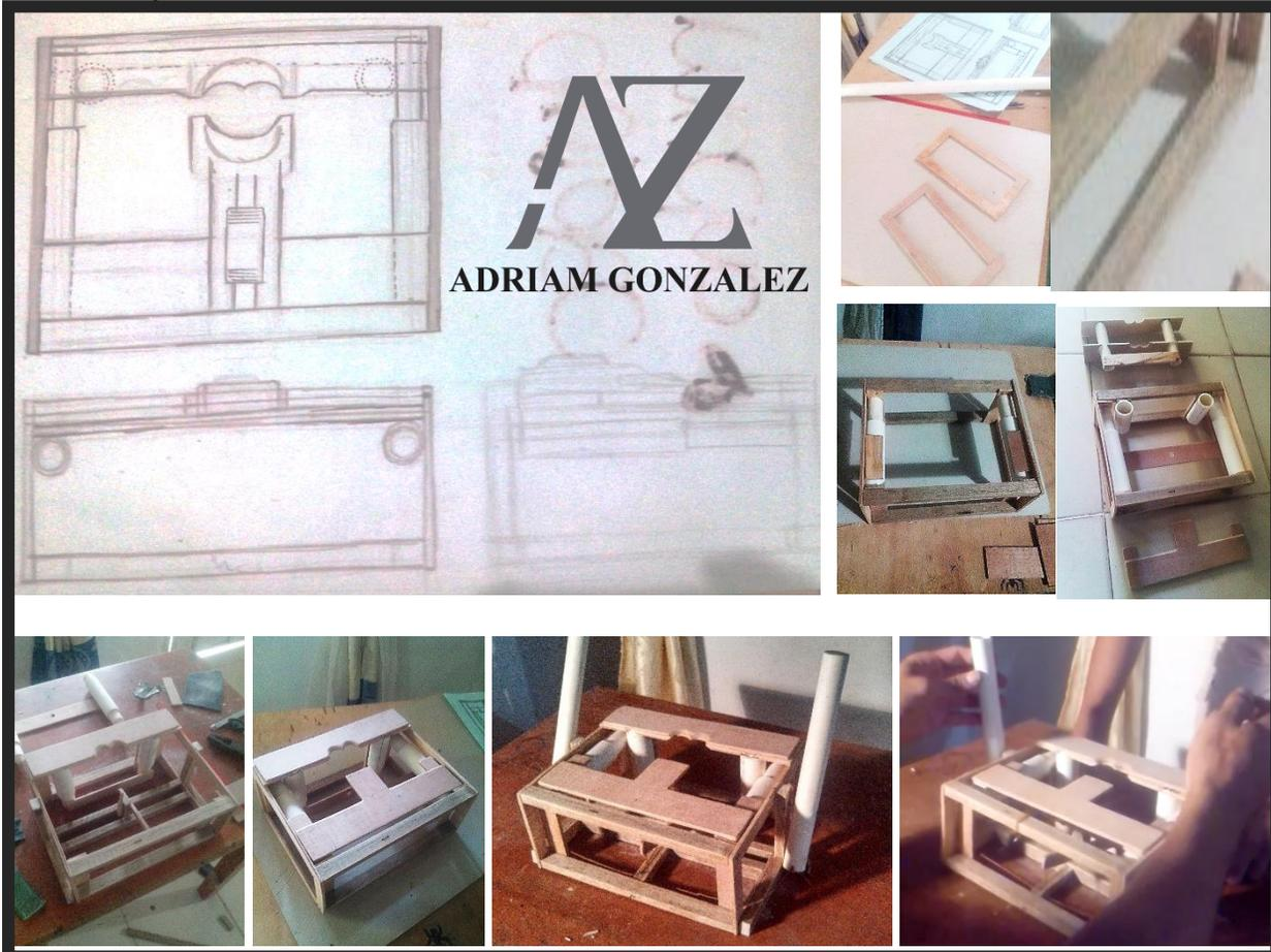
Este sistema es adaptado para acoplar de a 5 semillas gracias al sistema de cuchillas corredizas, donde se hala 2 palancas para eliminar el movimiento de la pierna al accionar el pedal y así descortezar las 5 semillas a la vez. (ver anexo 4)
