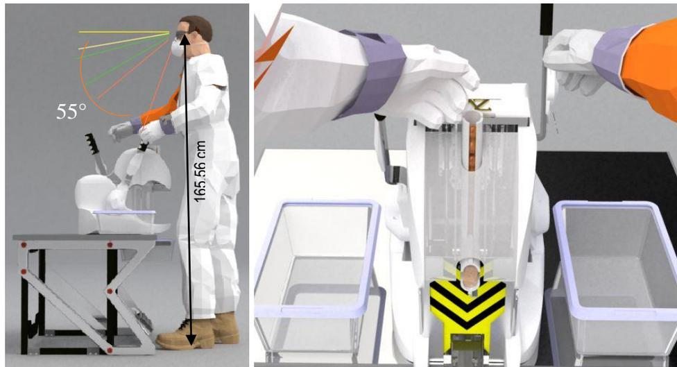
La posición de la maquina brinda un rango de visión a  $55^\circ$  desde la línea horizontal visible para el operario a la hora de recargar la tolva de alimentación con las semillas, según Peña (2008) la altura de los ojos está a 165,56 cm desde el suelo con el percentil 50, donde recubrimiento de la máquina los protege de cualquier salpicadura.
