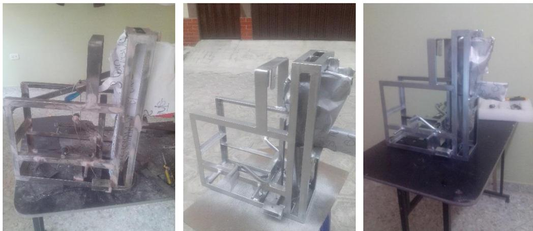
Desarmado de estructura, recubrimiento con masilla, lijado y pintado (González A. 2016)
