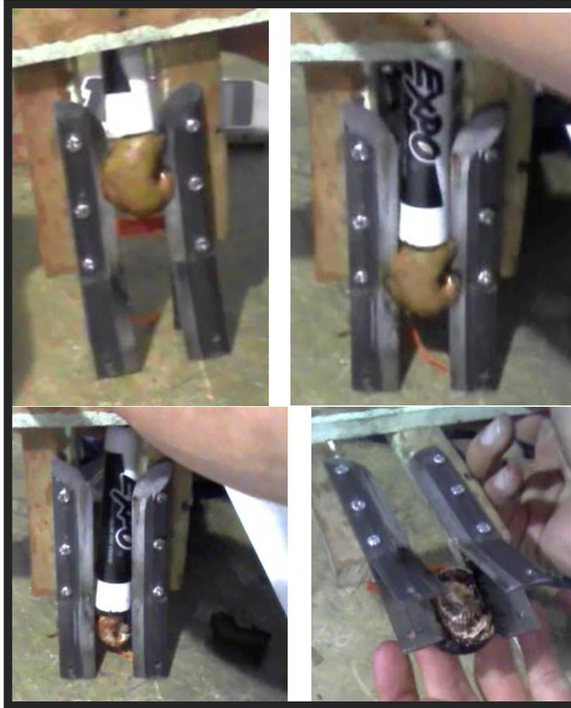
Gracias al sistema de cuchillas en “Y” se desliza la semilla a través de ellas para que al final se abra la cáscara debido a la forma en que están abiertas las cuchillas.
