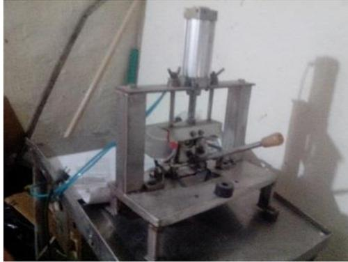
Figura 43. Descortezadora semiautomática para dos semillas, Industrias Kjú (González A, 2015)
