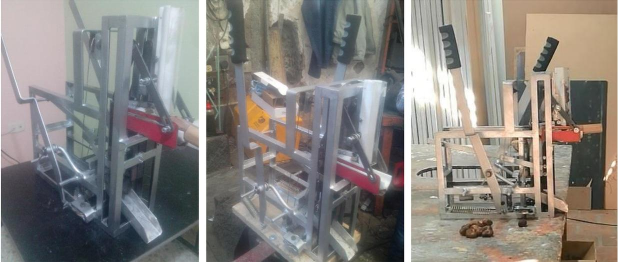
Ensamblado de partes pintadas, calibración de resortes ajustes de cuchillas e implementación de agarraderas (González A. 2016)
