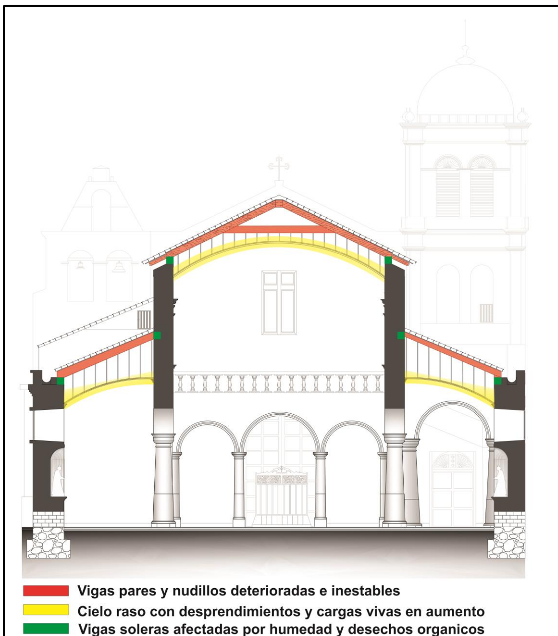
Imagen 35: distintas afectaciones sobre los elementos que componen la cubierta y cielo raso.
