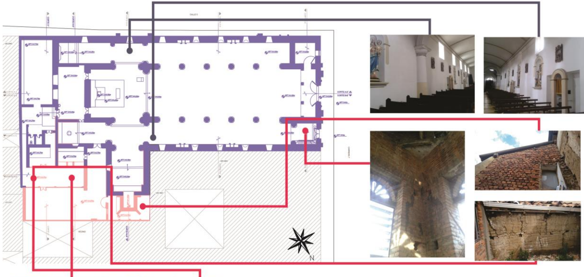
Muros de ladrillo cocido adosados a los muros de tapia para general nuevos espacios
