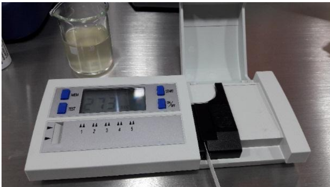
Figura 3. Medición de ácido láctico con Reflectómetro Reflectoquant RQflex plus 10.
