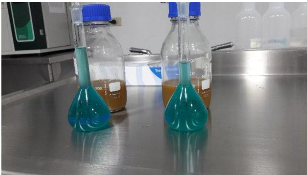
Figura 4. Dilución de muestra de mosto con adición de azul de metileno para recuento de levaduras.
