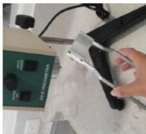
Apagar el motor de interruptor "OFF" para hacer cambio de aguja o cambio de muestra. Registrar la lectura en el formato 1 asegurándose de diligenciar todos los parámetros. Retirar la aguja y hacer la limpieza del equipo.
