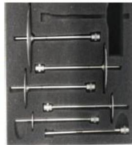
Seleccionar la aguja que se va a utilizar para la medición y ajustarla con mucho cuidado a la tuerca de acoplamiento del eje.
