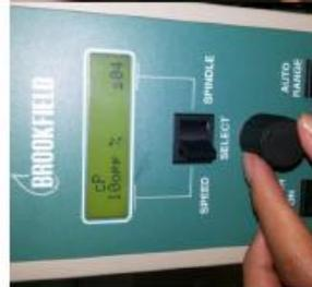
Ajustar el interruptor de velocidad/cabezal a la posición correcta girando el control SELECT hasta seleccionar el número del cabezal deseado y de igual forma para la velocidad. Una vez establecidos los parámetros ajustar el interruptor a la posición media.
