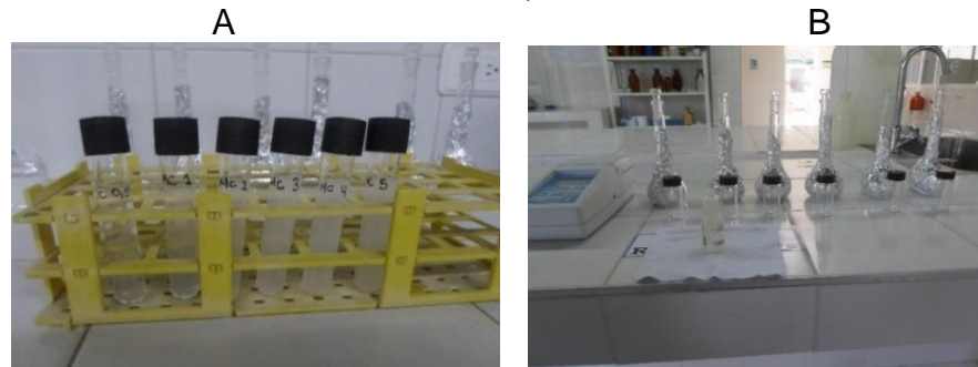
Figura 9. Patrón químico con \text{BaCl}_2 + \text{H}_2\text{SO}_4 : (A) Para medir espectrofotometría (B) Para medir turbiedad.
