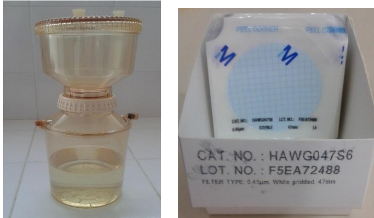
Figura 1. Equipo de filtración y filtros de membrana 0.45 µm Fuente: Autor
